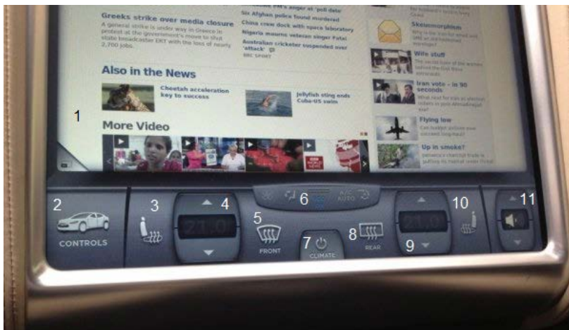
Fig. 2 Configurația afișajului de pe consola centrală a autovehiculului Tesla S [1]. 1-ecran tactil cu afișare informații internet s.a.; 2-buton software al ecranului tactil pentru accesarea comenzilor de control ale autovehiculului; 3-buton electronic pentru încălzire ; 4-reglajul nivelului de temperatură pentru sistemul de climatizare pentru conducătorul auto; 5- dezaburirea parbrizului; 6-panou de comandă pentru ventilație; 7-comanda climatronic; 8-dezaburire lunetă; 9-reglaj pentru nivelul de temperatură; 10-acționare încălzire scaun pasager; 11-buton de control multimedia (volum sonorizare)
