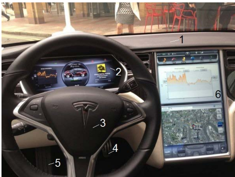
Fig. 1 Configurația postului de conducere la un autovehicul modern Tesla [1] 1-bordul autovehiculului; 2-panoul de afișare de la bord pentru conducătorul auto; 3-volanul de comandă; 4-pedala de accelerație; 5-pedala de frână; 6-info-ecran multimedia și accesorii
