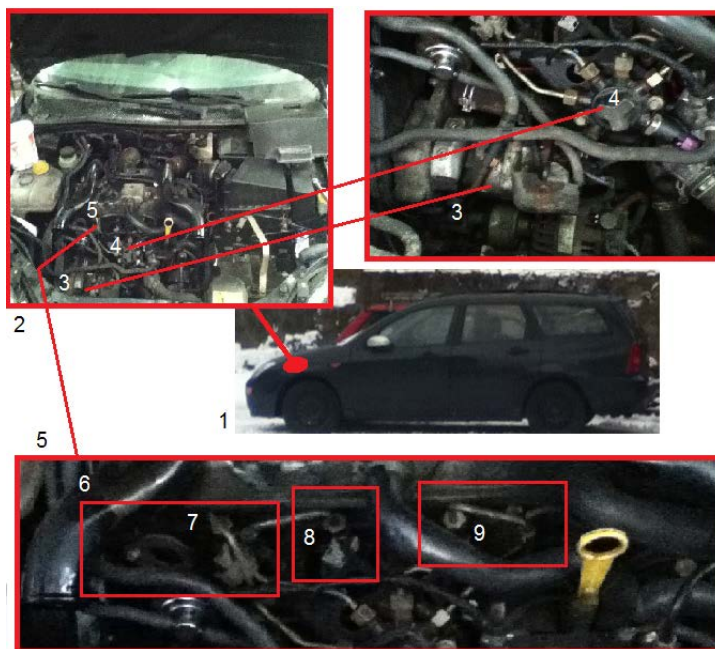
Fig. 1 Configurația sistemului de injecție de la motorul 1.8 I TDCI de la Ford Focus
