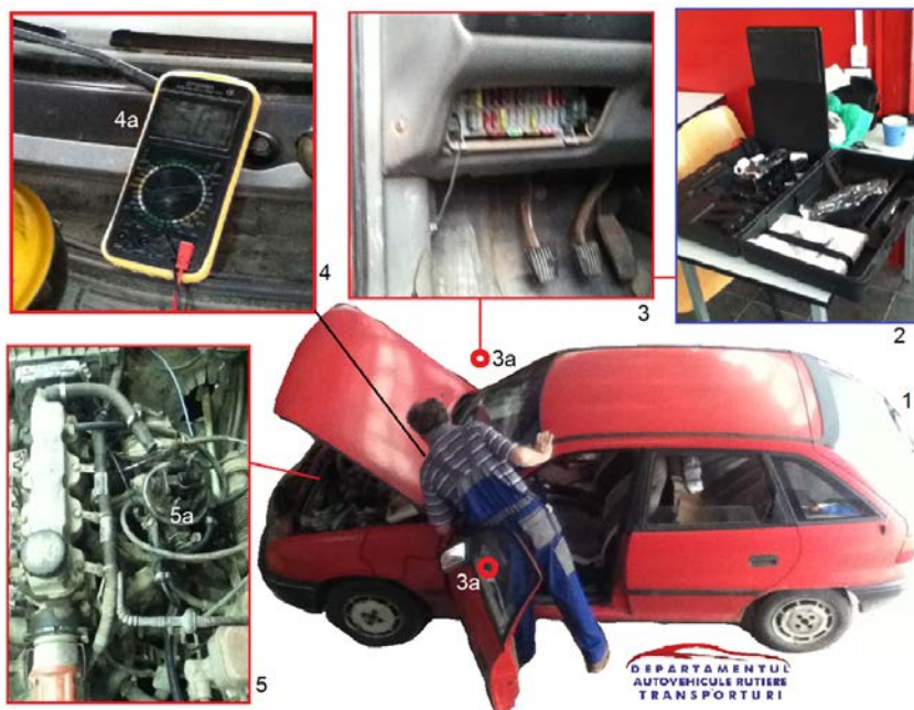
Fig. 1 Autovehiculul studiat și conexiunile cu părțile principale ale diagnosticării 1-autoturism marca Opel Astra F; 2-pachet aparatură diagnoză; 3-tablou electric de siguranțe și conexiuni pentru aparatura de diagnosticare; 3a-zona de conectare a interfeței pentru diagnosticare electronică a sistemului de management a injecției; 4-afișarea mărimilor electrice principale; 4a-multimetru pentru citirea rezistenței și continuității circuitelor electrice dintre sistemul electronic de control al motorului și senzorul de temperatură, respectiv injectorul; 5-compartiment motor cu aprindere prin scânteie și injecție de benzină monopunct gestionată electronic; 5a-unitate de injecție, al cărei corp este din aluminiu iar injectorul amplasat central controlează prin semnalele transmise de calculatorul sistemului electronic de control durata procesului de pulverizare a combustibilului în colectorul de admisie al motorului
