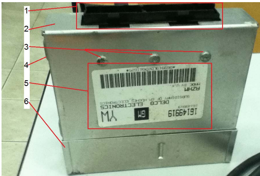
Fig. 2 Unitatea de calcul cu micro-procesor a sistemului electronic de control a injectiei la motorul cu aprindere prin scânteie al autovehiculului Opel Astra F 1-mufa de conexiune cu elementele sistemului electric-electronic; 2-suport metalic de rezistență pentru susținerea mufei de conexiune a calculatorului (unitate electronică de control); 3-elemente de asamblare; 4-protuberanțe de fixare a carcasei; 5-datele de identificare ale UEC; 6-capac inferior al carcasei metalice
