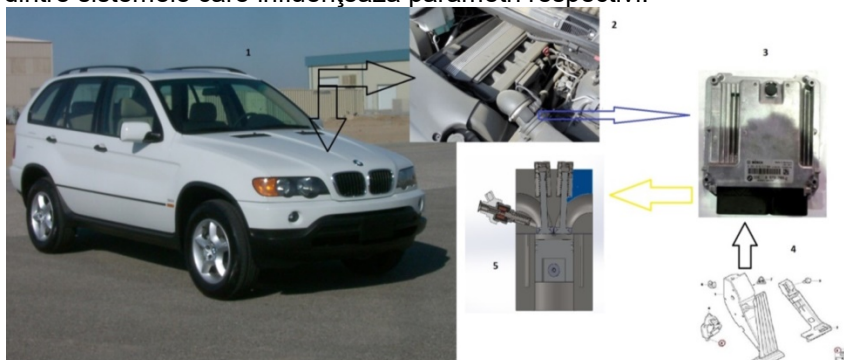
Fig. 1 Vehiculul supus testării în vederea analizei procesului de alimentare și a variației consumului de combustibil [8, 9, 10, 11]; 1-BMW X5, an fabricație 2002; 2-ansamblul motor 3.0i; 3-ECU (electronic control unit); 4-accelerator; 5-injectorul și camera de ardere.
