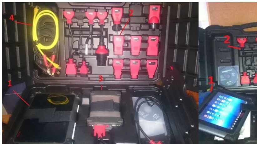
Fig. 2 Aparat de diagnosticare (Autel MaxiSys Pro); 1-interfața de afișare a datelor preluate; 2-adaptoare OBD; 3-interfața de citire a datelor; 4-cabluri pentru conectarea aparatelor
