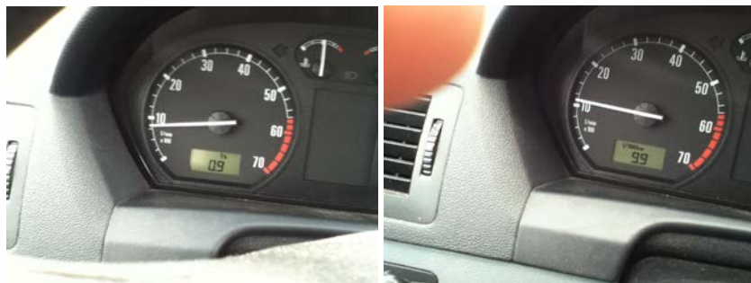
Fig. 8 Valori actuale ale consumului determinate în situații de trafic rutier a-consum în staționare cu motorul încălzit la temperatura nominală; b-nivelul consumului la urcare pe podul de pe strada Fabricii în treapta a patra înainte de retrogradarea în treapta a treia
