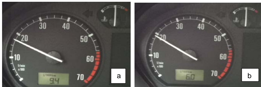
Fig. 4 Valori actuale ale mărimilor experimentale înregistrate în trafic urban a-consum urban în timpul efectuării unei depășiri obișnuite a unui vehicul lent; b-nivelul consumului în treapta a treia mers stabil cu viteza de 45÷50 km/h în localitate
