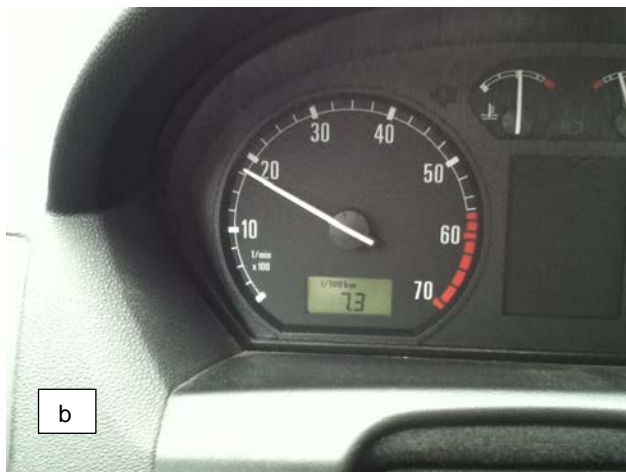
Fig. 7 Valori actuale ale mărimilor experimentale achiziționate în traficul rutier a-consum extraurban la 70 km/h în treapta superioară; b-consum extraurban la 110 km/h în treapta superioară
