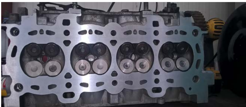
Fig. 10 Chiulasa autovehiculului Ford Focus după operația de rectificare
