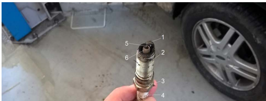
Fig. 4 Aspectul electrozilor bujiei și a izolației electrodului central 1-electrodul lateral al bujiei; 2-filetul de asamblare cu chiulasa; 3-corpul bujiei de forma hexagonală pentru prinderea cheii; 4-izolatorul exterior al bujiei; 5-vârful platinat al electrodului central; 6-izolatorul electrodului central înspre camera de ardere
