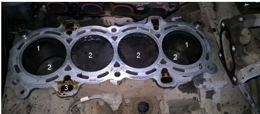
Fig. 11 Suprafața curățată și pregătită a blocului motor înainte de re-montarea chiulasei și a garniturii acesteia. 1-cilindru; 2-pistonul; 3-canalizație ulei; 4-labirint răcire; 5-suprafață de așezare
