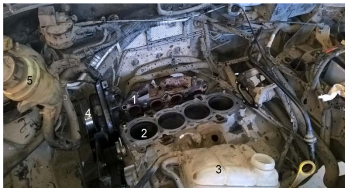
Fig. 8 Compartim- entul motor în timpul executării părții practice de constatare 1-galerie evacuare;
