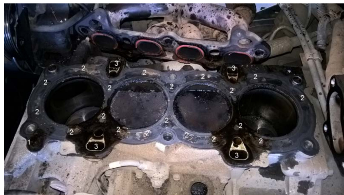
Fig. 7 Partea superioară a motorului după îndepăr- tarea chiulasei 1-canaliza- ție pentru ulei sub presiune; 2- instala- ție răcire; 3-căna- le pentru scurgere ulei
