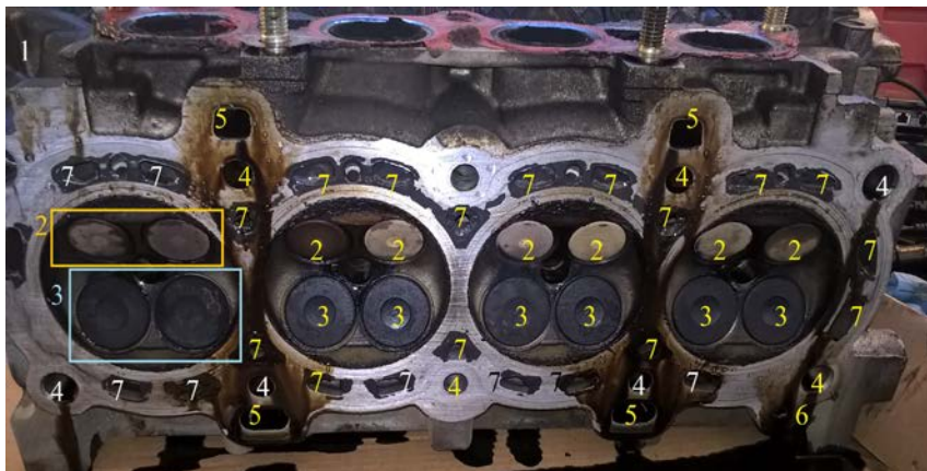
Fig. 2 Configurația părții inferioare a chiulasei de la motorul 1.6 l 16v Ford Focus FYDD 74 kW. 1-ansamblu chiulasă-supape; 2-supape de evacuare; 3-supape de admisie; 4-orificii de trecere pentru șuruburile de strângere; 5-orificii de scurgere a uleiului din chiulasă spre baia de ungere; 6-orificiu de presiune pentru pomparea uleiului în chiulasă; 7-orificii pentru circulația agentului de răcire
