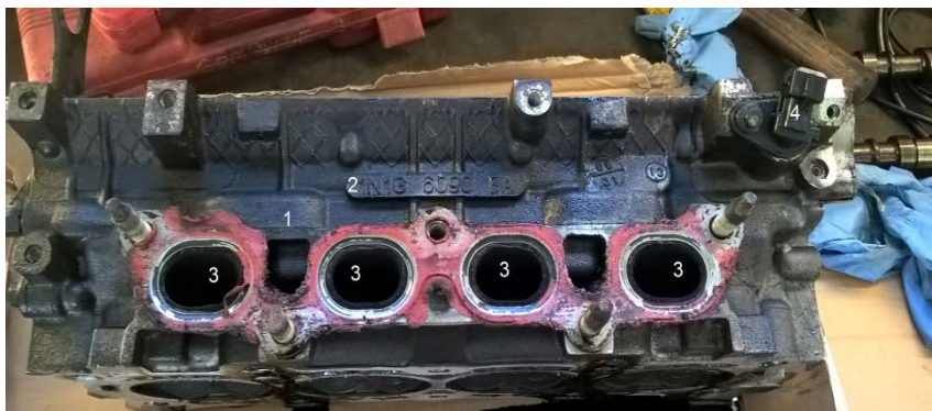
Fig. 9 Chiulasa-vedere laterală din spate, cu zona de fixare a galeriei de evacuare. 1-chiulasa; 2-cod chiulasă; 3-galerii de evacuare; 4-senzor de poziție
