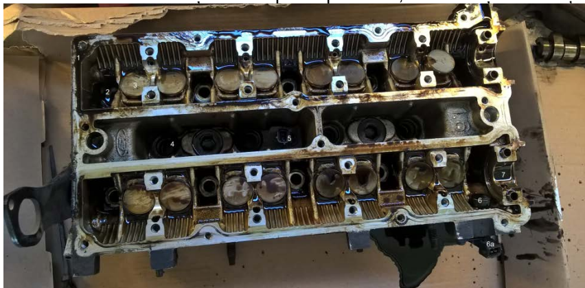
Fig. 3 Vedere de sus a ansamblului chiulasă de la motorul studiat 1-corp chiulasă; 2-găuri de strângere; 3-tacheți hidraulici; 4-orificii pentru bujii; 5-senzor temperatură; 6-senzor poziție arbore cu came; 6a-mufă senzor; 7-lagăr de alunecare
