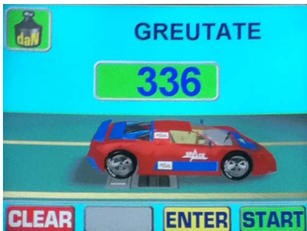
Fig. 2 Determinarea forței de greutate pe puntea spate a autovehiculului supus încercărilor experimentale
