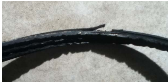
Fig. 10 Elementele sistemului de antrenare al alternatorului a-roata de curea; b-segment din cureaua de antrenare deteriorată
