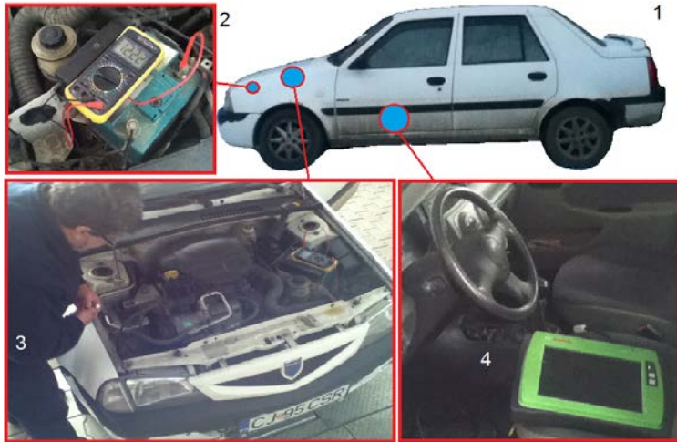
Fig. 3 Modul de amplasare a aparaturii de verificare a sistemului de încărcare a bateriei. 1-autovehicul supus cercetării experimentale; 2-montare și măsurători cu multimetrul; 3-verificare stare generator de curent; 4-conexiune OBD2 pentru aparatul de diagnosticare
