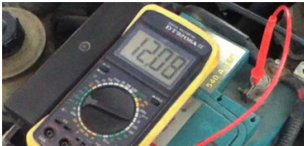
Fig. 6 Valoarea tensiunii de încărcare la bornele bateriei sub limita de 12,4 V după acționarea sistemului de climatizare, măsurată cu multimetrul
