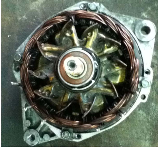
Fig. 9 Alterantorul demontat cu înfășurarea statorului și cea a rotorului
