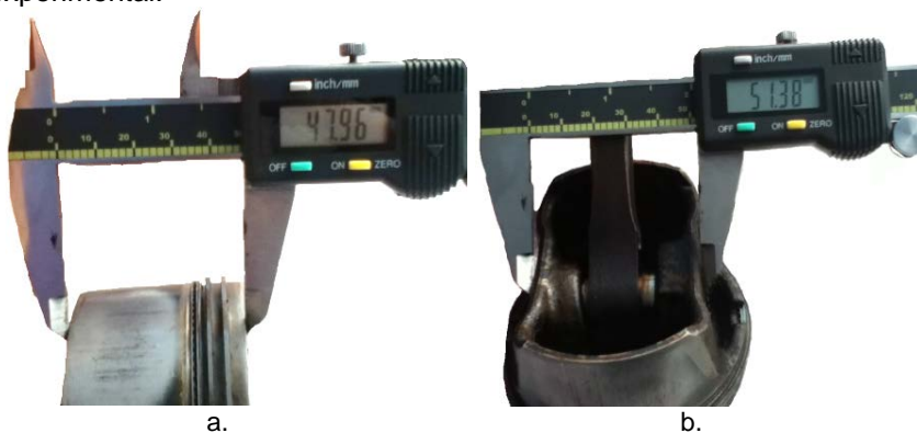
Fig. 5 Valorile efective ale determinărilor experimentale înregistrate pe piston a-înălțimea totală a pistonului; b-evazarea în zona umerilor bolțului
