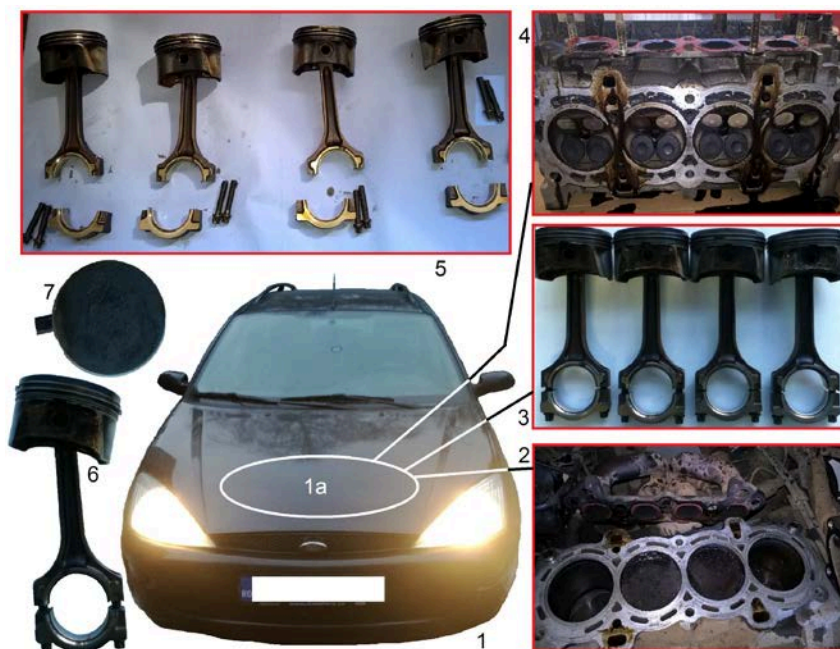
Fig. 1 Configurația principală a mecanismului motorului 1.6 16v de la Ford Focus. 1-autovehicul studiat; 2-carcasa motorului mono-bloc; 3-grupurile pistoane-biele; 4-ansamblul chiulasă+supape (16v); 5-ansamblul pistoane și biele dezasamblate de capurile acestora; 6-ansamblul piston, segmenti, bolț, bielă, cap bielă și șuruburi; 7-vedere frontală a capului pistonului
