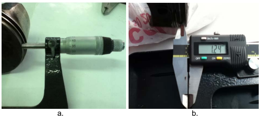
Fig. 4 Valorile actuale ale determinărilor experimentale înregistrate pe piston a-micrometrarea capului pistonului deasupra segmentului de foc (78,380 mm); b-măsurarea cu șublerul a înălțimii canalului segmentului de foc (1,24 mm)
