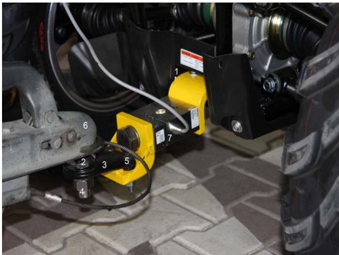
Fig. 4 Soluția de cuplare a remorcii la cârligul vehiculului tot- teren (ATV) 1-cadru ATV- ului; 2-cârligul de remorcare; 3-placa suport pentru cârlig; 4-asamblarea filetată a cârligului pe placa suport proprie; 5- asamblarea
