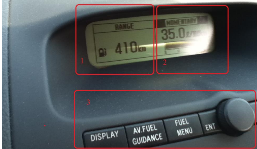
Fig. 4 Valori reale ale disponibilității de deplasare și a consumului instantaneu de carburant indicat digital la bordul autovehiculului studiat 1-autonomie; 2-consum instantaneu în timpul opririi autovehiculului cu motorul pornit; 3-navigații în meniul de control și afișare a parametrilor de consum și autonomie
