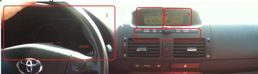
Fig. 3 Modul de amplasare a aparaturii de bord și reprezentarea grafic-digitală simplificată a mărimilor caracteristice evoluției consumului de combustibil 1-plașa de bord; 2-autonomia de combustibil; 3-afișajul digital al consumului instantaneu de hidrocarburi; 4-butoane de acționare a sistemului de management și afișare a mărimilor privitoare la consumul de hidrocarburi al motorului în diferite condiții de deplasare a autovehiculului
