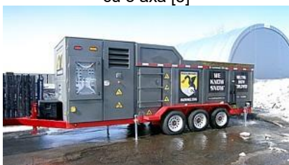
Fig. 7 Model Snow Dragon cu trei axe [2]
