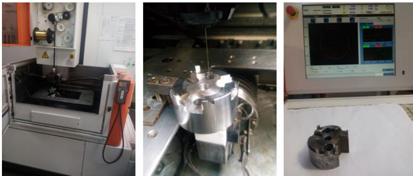
Fig. 6 AGIE CHARMILLES CUT 20 în acțiune
