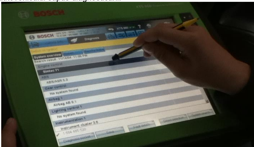
Fig. 8 Accesarea sistemului Simtec 71 de gestionare electronică a motorului de la autovehiculul rutier Opel Zafira
