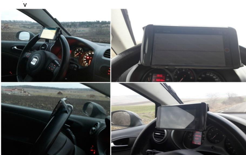
Fig. 5 Sistemul de fixare a dispozitivului inteligent pe volanul autovehiculului
