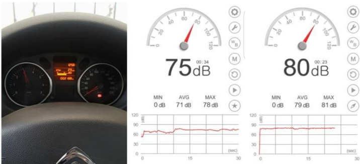
Fig. 7 Valori reale privitoare la nivelul de zgomot din habitacul autovehiculului și din compartimentul motor la 3000 rot/min
