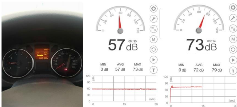
Fig. 3 Valori reale privitoare la nivelul de zgomot din habitaclul autovehiculului și din compartimentul motor la 1000 rot/min.
