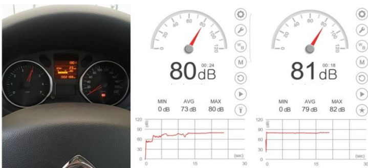
Fig. 9 Valori reale privitoare la nivelul de zgomot din habitaclul autovehiculului și din compartimentul motor la 4000 rot/min
