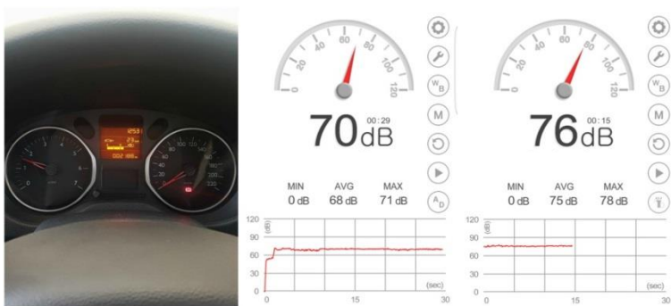
Fig. 4 Valori reale privitoare la nivelul de zgomot din habitaclul autovehiculului și din compartimentul motor la 1500 rot/min.
