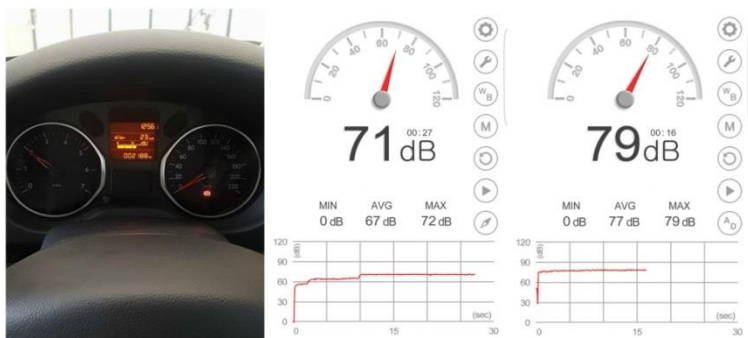
Fig. 5 Valori reale privitoare la nivelul de zgomot din habitaclul autovehiculului și din compartimentul motor la 2000 rot/min
