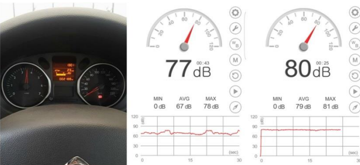
Fig. 8 Valori reale privitoare la nivelul de zgomot din habitacul autovehiculului și din compartimentul motor la 3500 rot/min
