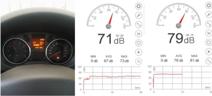
Fig. 6 Valori reale privitoare la nivelul de zgomot din habitacul autovehiculului și din compartimentul motor la 2500 rot/min
