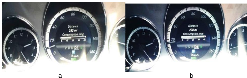
Fig. 6 Înregistrarea consumului la demaraj în D1 și în treapta superioară D6 a-demaraj de pe loc D1 (0÷15 km/h); b-dezvoltare frână de motor D6
