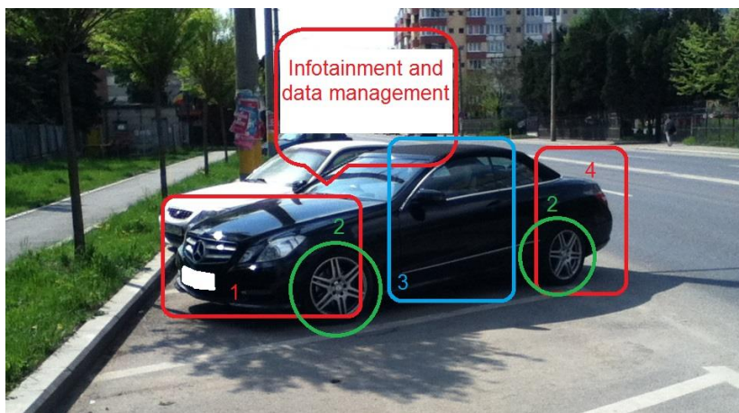
Fig. 3 Structura arhitecturală de bază a vehiculului studiat Mercedes e class Coupe. 1-zona de amplasare a motorului; 2-trenul de rulare; 3-habitacul; 4-compartmentul de bagaje
