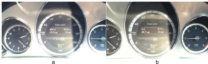
Fig. 5 Înregistrări în treapta de croazieră D6 în modul de schimbare a vitezelor a-inițiere frână de motor; b-dezvoltare frână de motor
