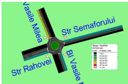
Fig. 4 Vehicule oprite în noua intersecție
