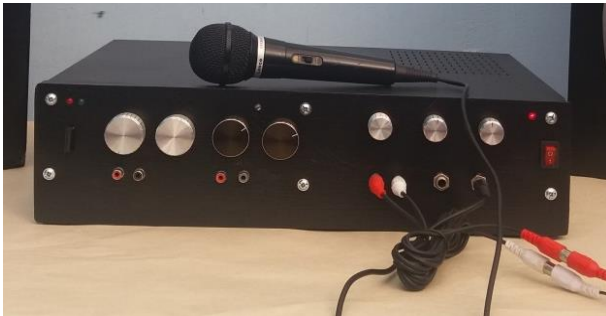
Fig. 6 Amplificatorul audio de putere (2 x 100 W) – UEMR
