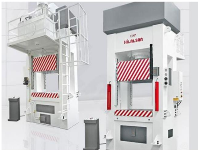
Fig. 3 Presă hidraulică de ambutisat tablă HSP 500 HILALSAN [7]
