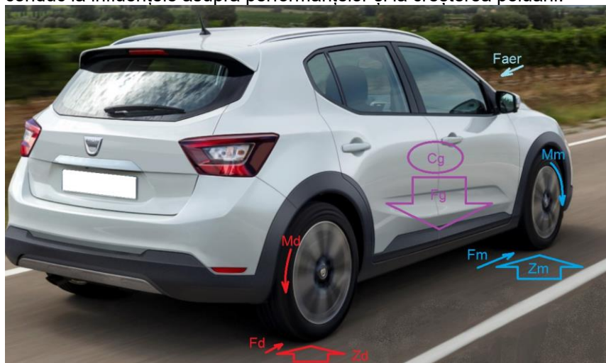
Fig. 2 Aplicarea componentelor dinamice cu influență asupra performanțelor F_{aer} este rezistența aerodinamică; F_m -forța de rezistență la rulare în cazul roții motoare; F_d -forța de rezistență la rulare în cazul roții conduse; F_g -forța de greutate; Z_d -reacțiunea căii de rulare în cazul roților conduse; Z_m -reacțiunea căii de rulare în cazul roților motoare; C_g -centrul de greutate al autovehiculului Dacia Sandero; M_m -momentul motor aplicat pe puntea față a autovehiculului Sandero; M_d -momentul roți conduse, manifestat pe puntea spate nemotoare
