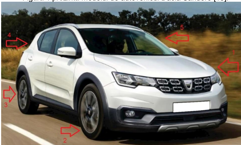
Fig. 1 Dacia Sandero modelul nou, vedere isometrică dreapta-față [19] 1-compartiment motor; 2-punte motoare față; 3-roți conduse, puntea spate nemotoare; 4-compartiment bagaje, haion spate; 5-compartiment pasageri
