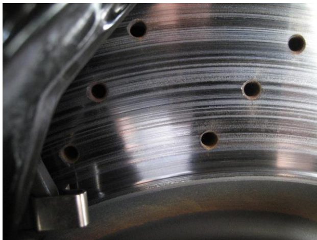
Fig. 3 Disc de frână perforat cu fisuri [2]
