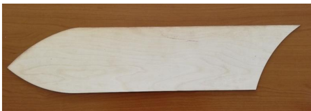
Fig. 2 Vedere laterală a fuzelajului din placaj de mesteacăn
