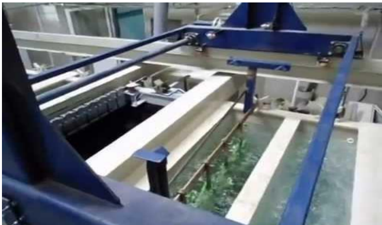
Fig. 3 Instalație de nichelare/cromare
