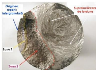
Fig. 3 Suprafața tipică de rupere prin oboseală.
