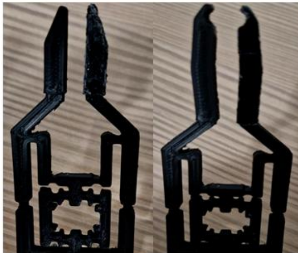
Fig. 9 - Griper compliant cu diferite modele de „pensete” atașate
