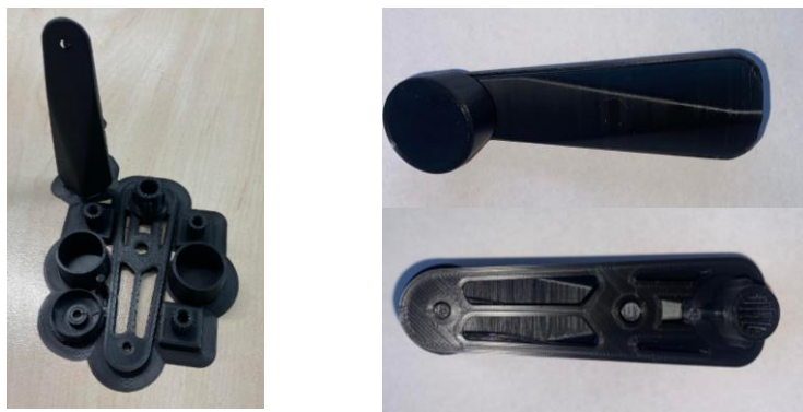
Fig. 7. Piesele realizate pe imprimanta 3D și asamblarea finală.
