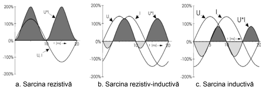
Fig. 1 Curentul și tensiunea rețelei de alimentare
