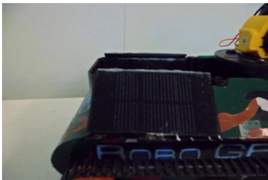
Fig. 6 Montarea celulelor fotovoltaice pe structura minirobotului
