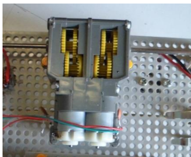
Fig. 3 Montarea cutiei de viteze pe structura minirobotului
