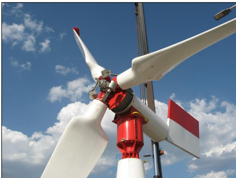
Fig. 1 Turbina eoliană proiectată și realizată de Universitatea "Politehnica" Timișoara în cadrul Grant-ului RO-0018/2009, D = 7 m
