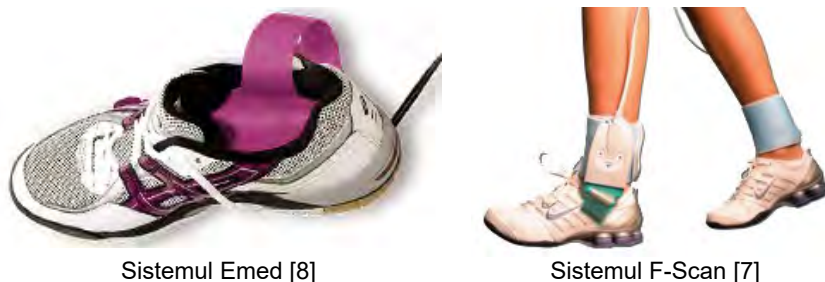
Fig. 2 Sisteme de măsurare a presiunilor plantare care se introduc în interiorul încălțămintei: a) Emed; b) F-Scan
