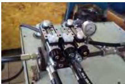
Fig. 6 Blocul hidraulic de ridicare
