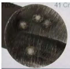
Fig. 1 Oțelul analizat cu ajutorul spectrometrului
