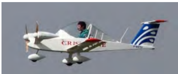
Fig. 1 Avionul Cri-Cri în varianta MC15E cel mai mic avion bimotor cu motoare electrice
