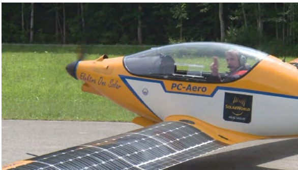
Fig. 6 Avionul solar Electra e-One realizat de PC-Aero în Germania (decolare și în zbor 2015)
