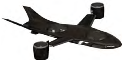
Fig. 7 Aeronava cu decolare verticală Boeing VTOL X-Plane de tip Phantom Swift
