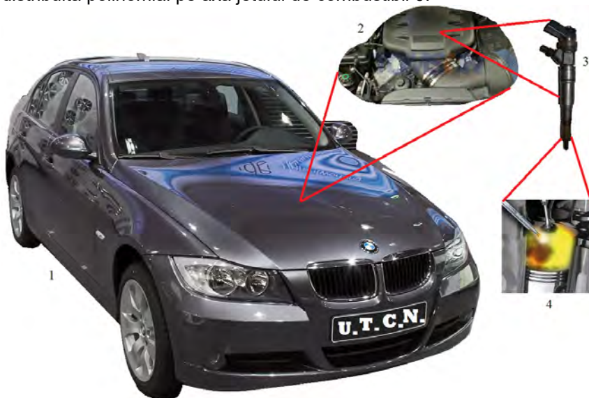
Fig. 1 Vehicul testat în vederea analizei sistemului de injecție 1 – vehicul BMW anul fabricației 2005 0; 2 – ansamblul motor 0 2000 \text{cm}^3 ; 3 – ansamblul injector electromagnetic; 4 – proces injecție și ardere
