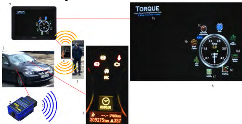
Fig. 2 Sistemul comunicațional realizat în vederea determinării experimentale a parametrilor injecției
