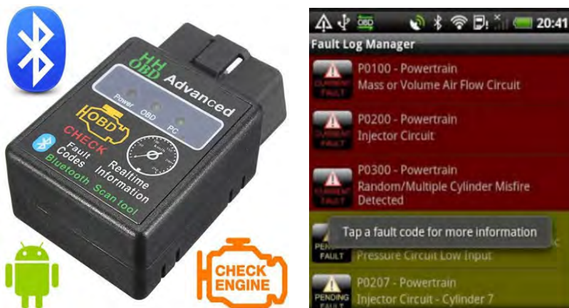
Fig. 1 Interfață diagnosticare HH OBD MINI ELM327V2.1 [4, 5]
