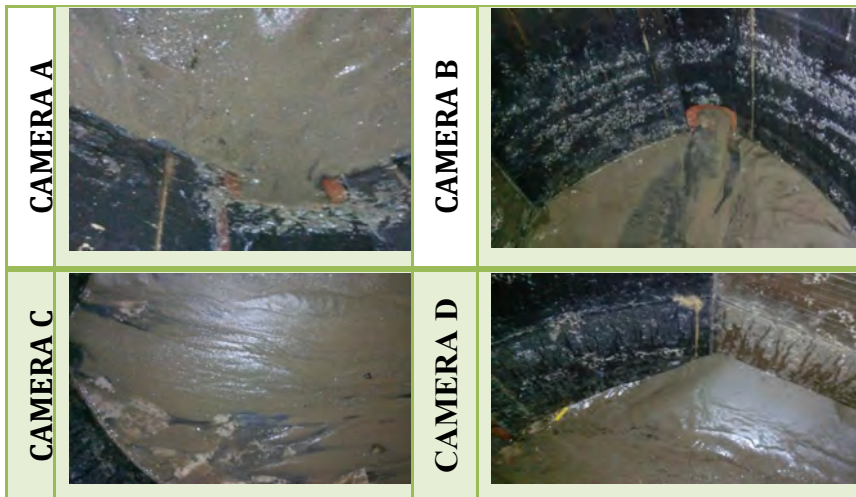
Fig. 8 Colmatarea camerelor A,B,C,D după prima scurgere (experimentul 2), [4]
