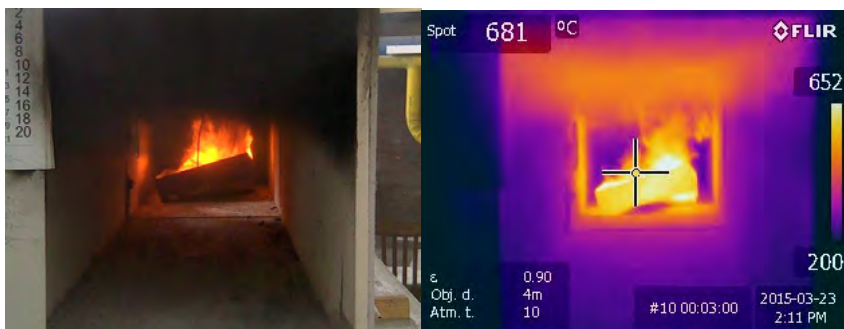
Fig. 2 În partea stângă, imagine surprinsă de camera foto din care reiese dezvoltarea incendiului și dispersia stratului de fum; în partea dreaptă același moment surprins de camera termică, de unde reiese nivelul de temperatură instantanee de 681 °C
