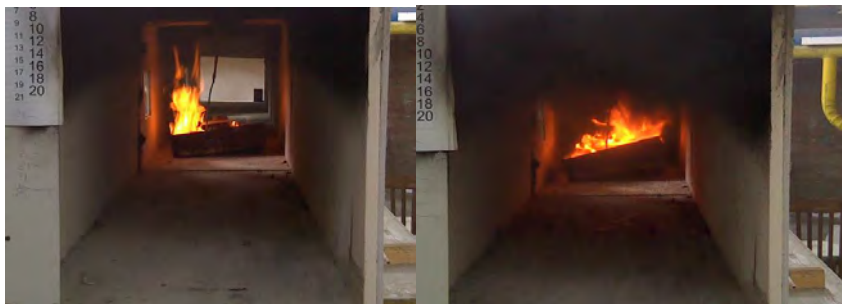
Fig. 1 Imagini de la testul cu macheta auto, în cadrul tubulaturii de tunel; se observă incendiul dezvoltat în întreaga masă a machetei auto din plastic și a etanolului
