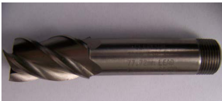
Fig. 1 Freză cilindrofrontală având suprafața elicoidală de degajare rectificată conform cerințelor actuale
