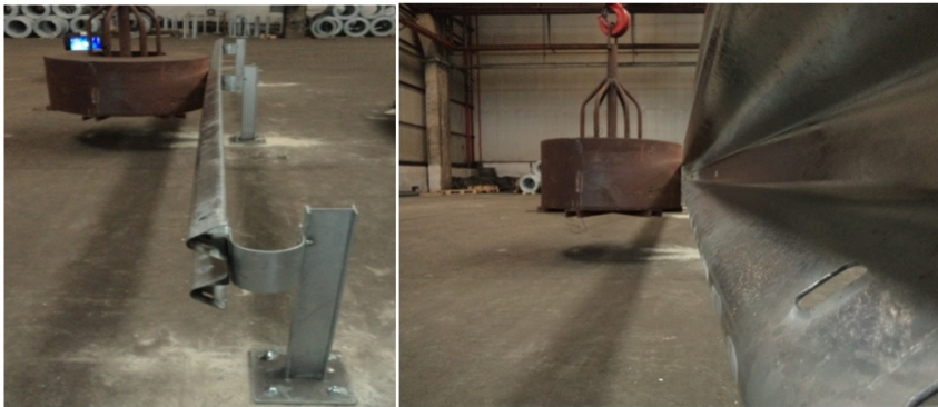
Fig. 3 Poziționarea parapetului și a pendulului
