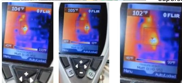
Fig. 11 Temperatura maximă măsurată pe supercondensator, pentru FLUKE 289: a. 40 °C; b. 40,55 °C; c. 38,89 °C
