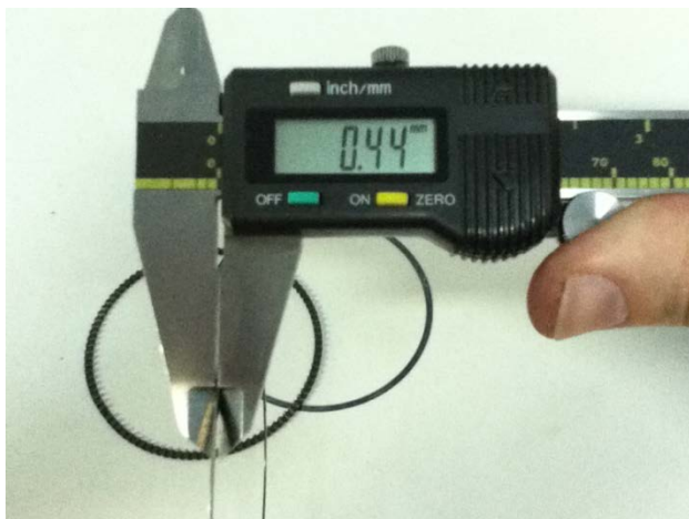
Fig. 11 Determinarea înălțimii pentru semisegmentul racilor inferior
