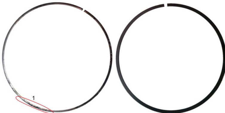
Fig. 2 Configurația segmentului de foc de la motorul 1.6 16v Ford Focus FYDD 74 kW. a-imaginea reală; b-imaginea procesată; 1-zonă cu uzură accentuată
