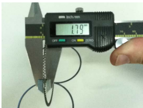
Fig. 10 Determinarea înălțimii expandorului pentru segmentul raclor
