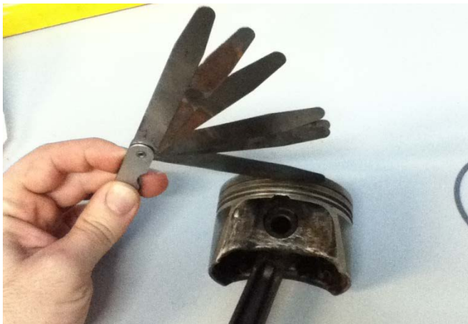
Fig. 5 Determinarea înălțimii canalului pentru segmentul de foc
