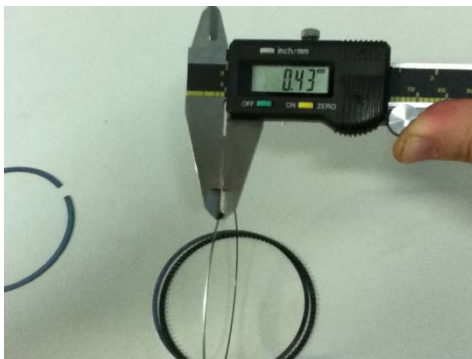
Fig. 9 Determinarea înălțimii pentru semisegmentul superior
