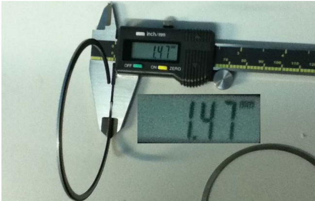
Fig. 8 Determinarea înălțimii pentru al doilea segment de compresie
