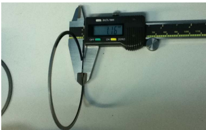
Fig. 6 Determinarea înălțimii canalului pentru segmentul raclor
