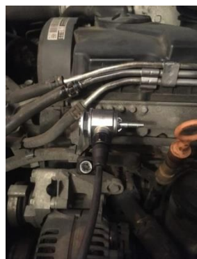
Fig. 6 Ansamblu accelerometru pe urechea blocului motor; 1-jojă de ulei; 2 – bloc motor; 3 – accelerometru piezoelectric; 4 - alternator
