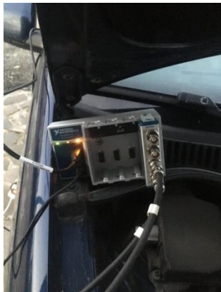
Fig. 7 Ansamblu șasiu și senzori; 1 – cablu conectare senzor piezoelectric la placa de achiziție de date NI-9234; 2 – Șasiu achiziție date cDAQ-9174 ; 3 – cablu USB între șasiu și PC ; 4 – cablu alimentare curent șasiu
