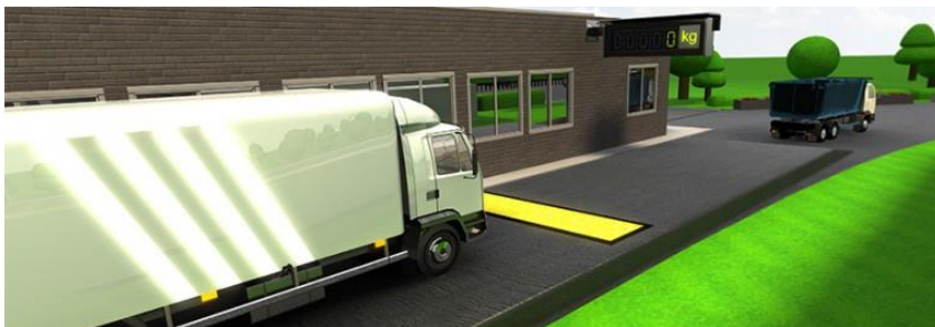
Fig. 3 Reprezentare tehnică de cântărire Low Speed WIM
