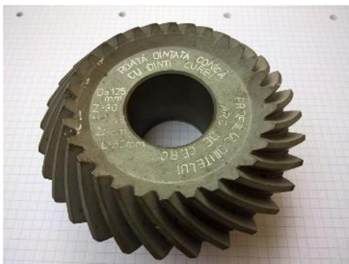
Fig. 11 Roata dințată conică cu dinți curbi DE 125 mm Z30 m-2,5 mm Coordonator proiect prof. Univ. Onorific Dr. Ing. Mihai Sudrijan
